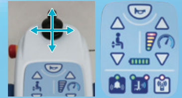
レバー(ジョイスティック)を倒した方向に進みます
